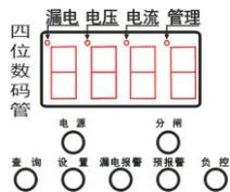
1) 由一块4位数码管为主要信息显示，左起首位字符形成代码，配合相关指示灯表达各种参数和信息。后三位数码管是数值区，超过999时显示999（如显示L999，上方漏电指示灯亮，分闸指示灯亮，表示漏电动作，漏电值为999mA）。
